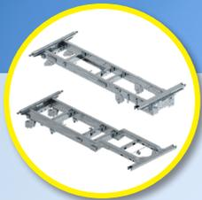
**Robustez:** bastidor tubular galvanizado y fondo de caja de acero especial (4 mm)
